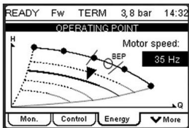
Дисплей графического терминала
