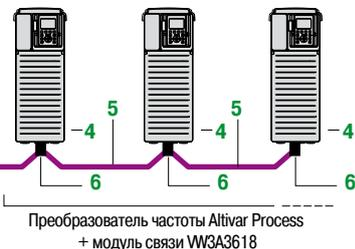
Пример подключения преобразователей частоты к шине CANopen при помощи разъемов типа SUB-D
