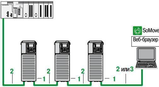
Преобразователь частоты Altivar Process + модуль связи WW3A3720
