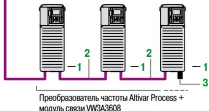
Оптимальное решение - подключение преобразователей частоты «шлейфом» на шину CANopen
